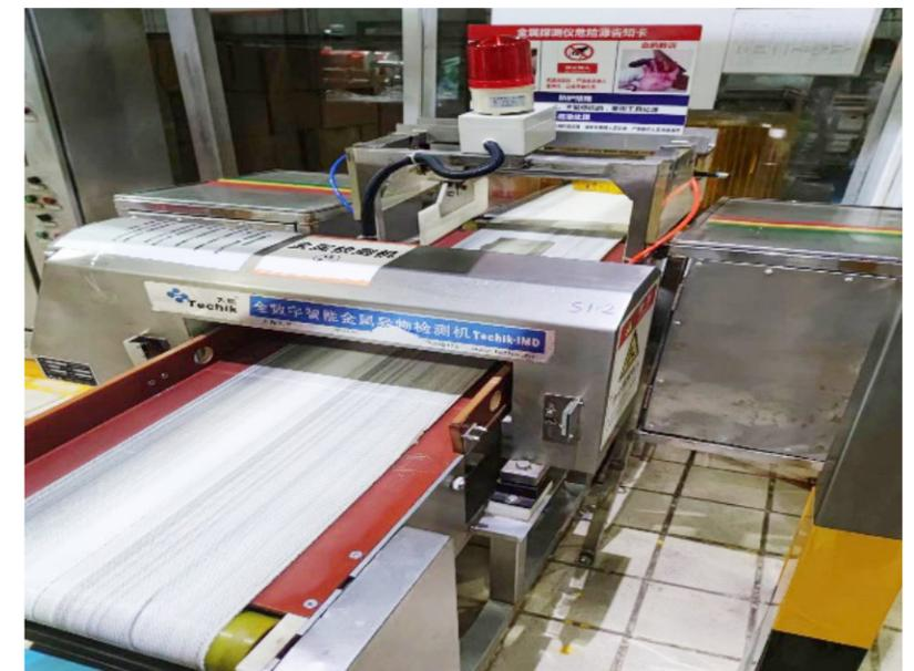
浙江五丰冷食利用金属探测仪检测原料中的金属异物
